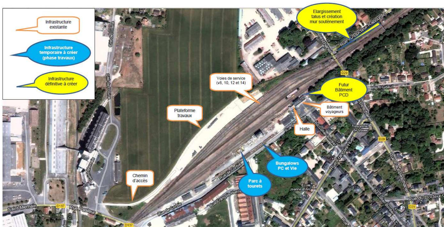
Travaux en gare de Voves (s'ajoutent les aménagements du plan de voies et des quais)
