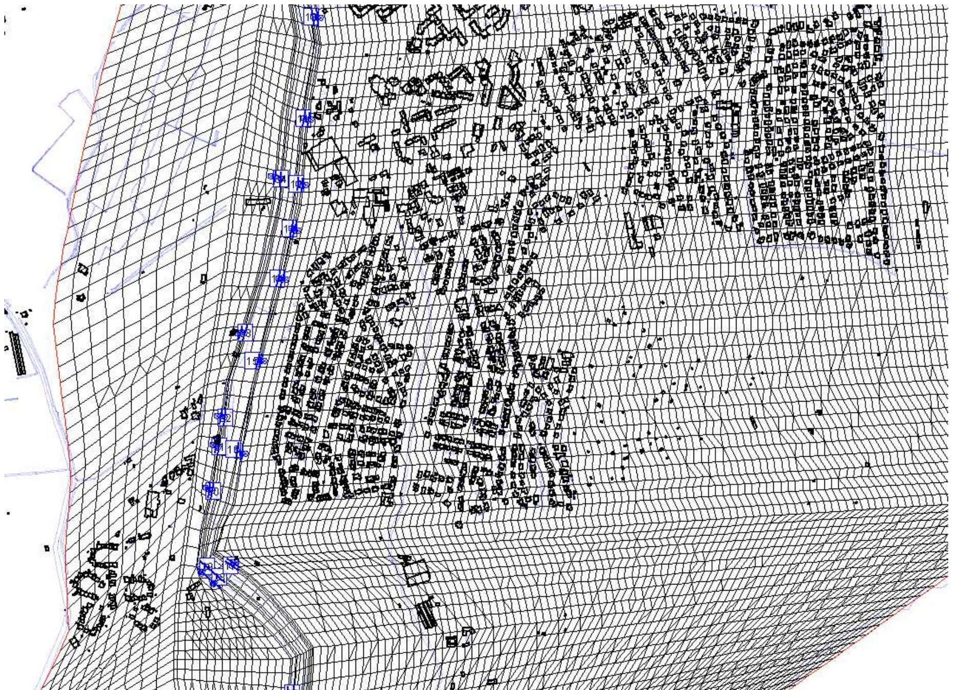
Figure 1c - Maillage de calcul et localisation des brèches (planches a à d du Nord au Sud)
