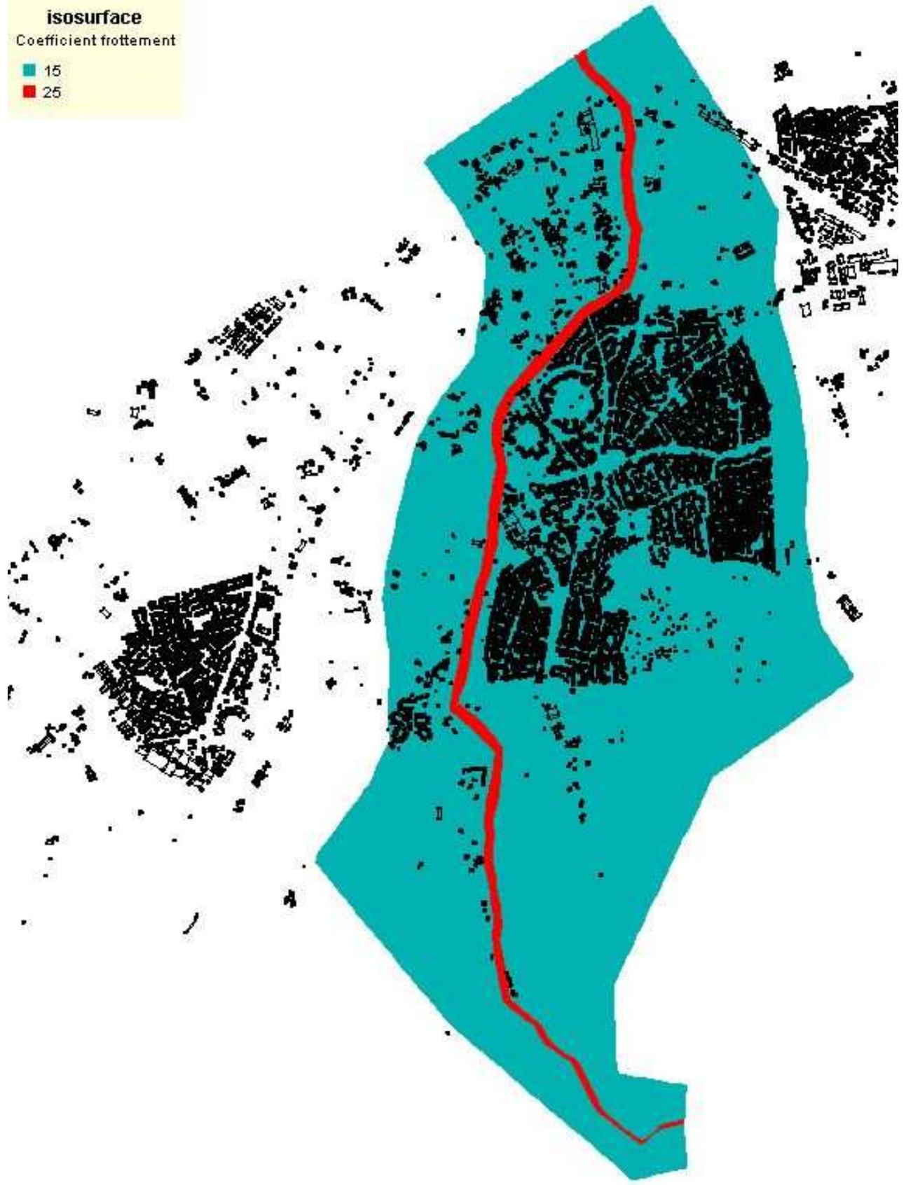
*Figure 3 - Coefficients de Strickler utilisés*
