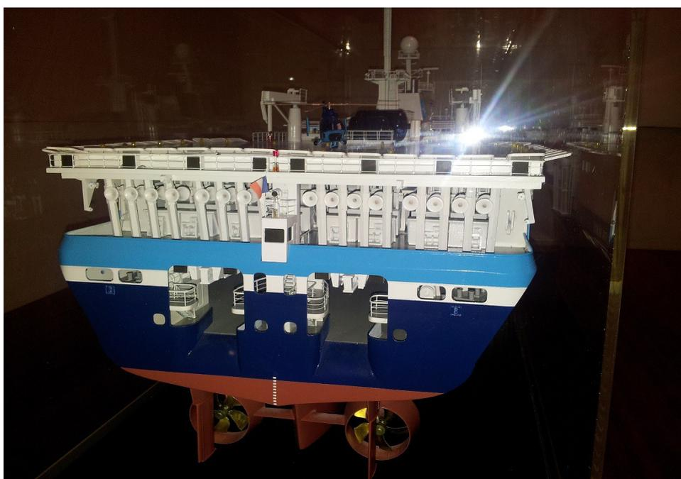
Arrière d'un navire de prospection sismique, montrant à l'arrière les 16 lignes de traction des canons à air (Photo Patrick Palus :Maquette du navire CGG-Alizé propriété de Louis Dreyfus Armateurs)
