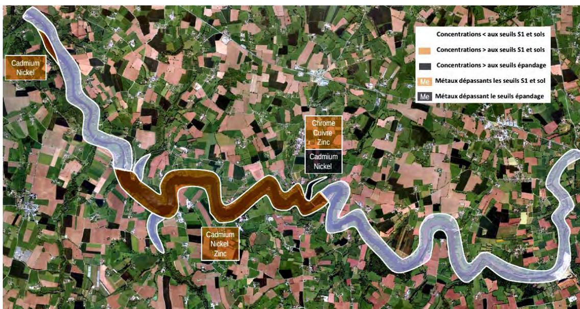
Illustration 9: vue satellitaire du site des retenues où les concentrations de métaux dans les sols sont figurés selon le niveau de dépassement de la norme d'épandage ou du niveau seuil S1 dans les sols.
