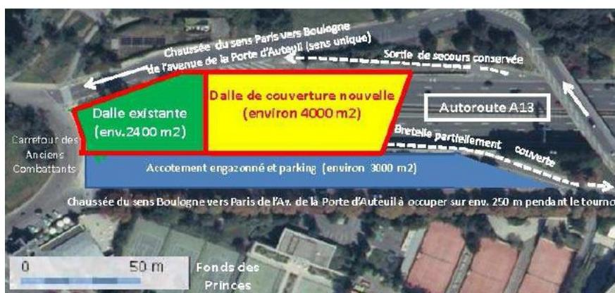
Il faut comprendre que, la bretelle de sortie étant située sous la nouvelle couverture, il faut surélever le niveau de la dalle vers l'est en fonction du niveau de la bretelle. De plus, la surface de la dalle devant être nécessairement horizontale pour y installer des courts, différents niveaux sont à prévoir en montant d'ouest en est.
