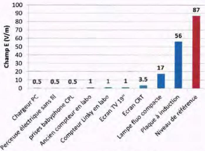
Figure 3 : comparaison des niveaux de champ électrique à 30 cm d'un compteur Linky avec d'autres équipements domestiques<sup>4</sup>
