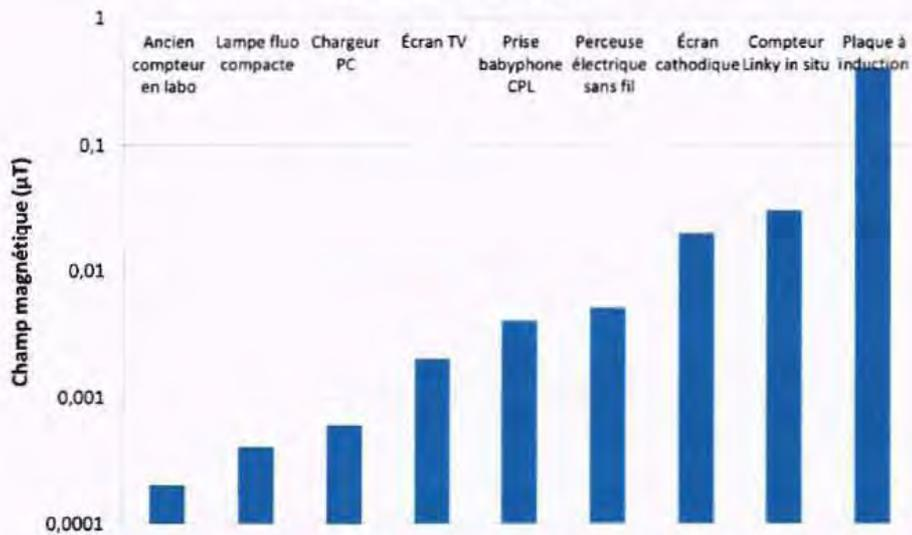
Figure 4 : comparaison des niveaux de champ magnétique à 30 cm d'un compteur Linky avec d'autres équipements domestiques<sup>5</sup>
