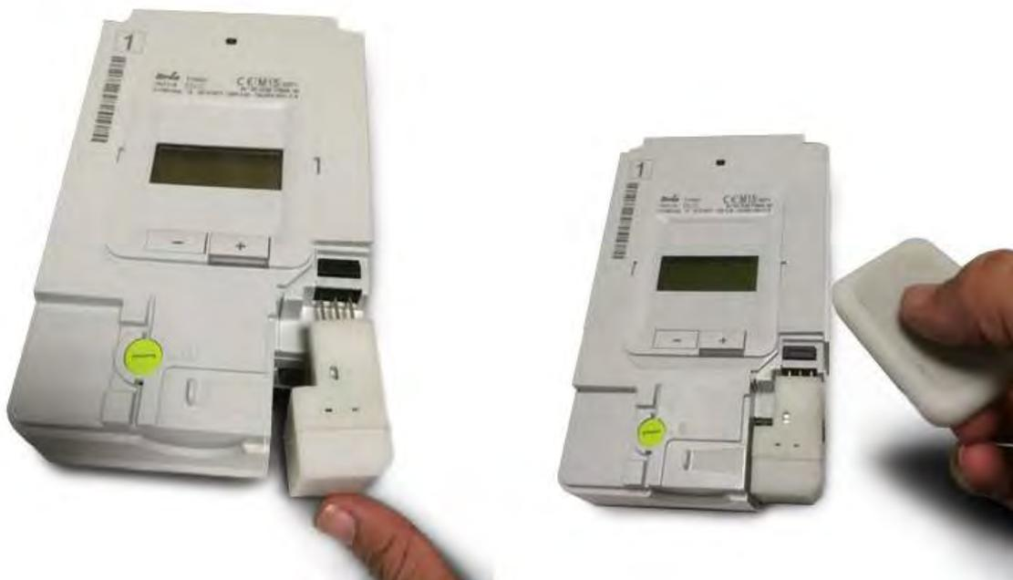
Deux types de protocoles sont utilisés pour retransmettre les données de comptage : Zigbee et KNX, protocoles d'origine domotique, fonctionnant respectivement à 2,4 GHz et 868 MHz. Le Wifi n'est pas supporté, en raison, selon Enedis, d'une puissance trop faible sur la prise TIC et d'une portée trop limitée.
