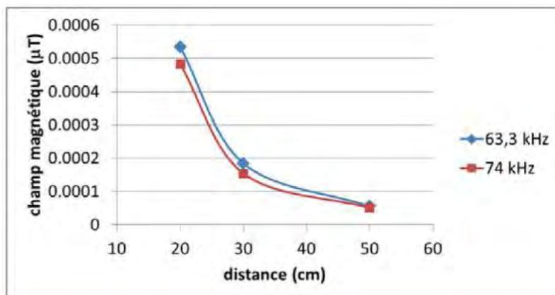
décroissance du champ magnétique en fonction de la distance en face avant du compteur G1 en communication
