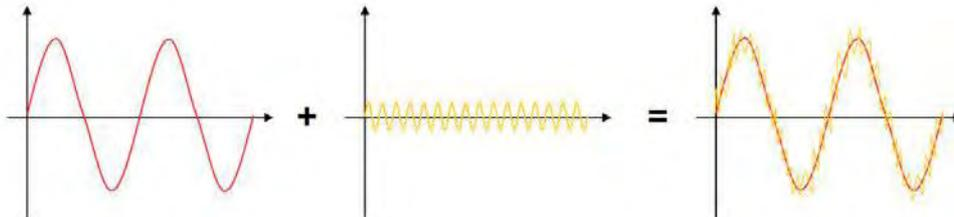
Figure 2 : illustration du principe général du CPL c'est-à-dire la superposition d'un signal 50 Hz à un signal plus haute fréquence
