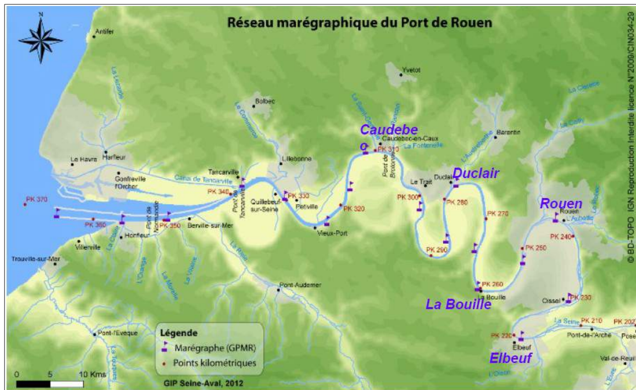
Figure 36: instrumentation du tronçon Seine aval, marégraphes du GPMR, et les 5 marégraphes de référence, fond GIP SA 2012 - Source SPC Seine aval et Côtiers normands
