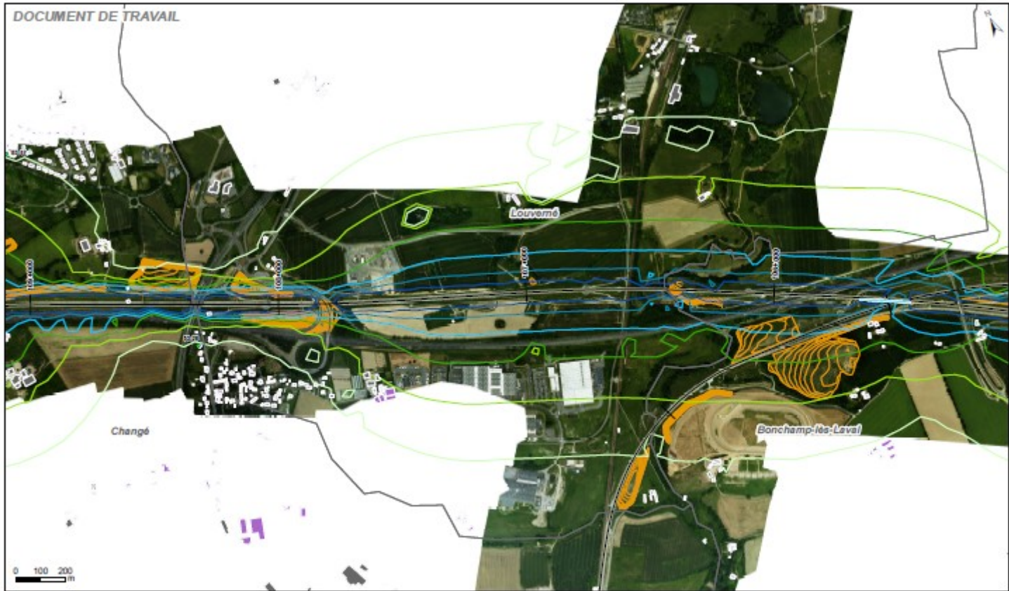
LGV Bretagne-Pays de la Loire - Cartographie des pics de bruit (LAmax selon méthode nordique) Passage d'un TGV-A-US à V = 320 km/h Légende — Limite départementale — Ecran acoustique Isophone LAmax en dB(A) — 75 — Limite communale — Merlon acoustique — 90 — 70 — Axe des voies — Aménagement paysager — 85 — 65 ● Point de mesure ■ Bâti habité — 80 ■ Bâti non habité Page 30 sur 50
