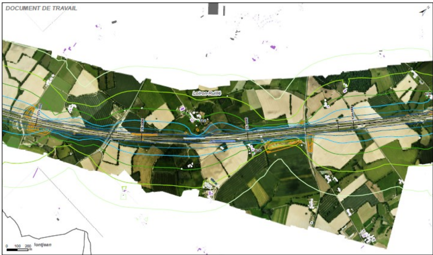
Légende Limite départementale Écran acoustique Isophone LAmax en dB(A) 75 Limite communale Muron acoustique Isophone LAmax en dB(A) 70 Axe des voies Aménagement paysager Isophone LAmax en dB(A) 65 Point de mesure Bât habité Isophone LAmax en dB(A) 60 Bât non habité LGV Bretagne-Pays de la Loire - Cartographie des pics de bruit (LAmax selon méthode nordique) Passage d'un TGV-A-US à V = 320 km/h Page 35 sur 50
